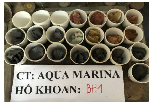
Hình 45: Thí nghiệm độ ẩm
