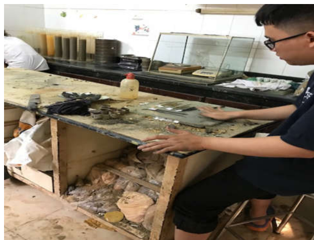
Hình 46: Thí nghiệm chảy – dẻo
