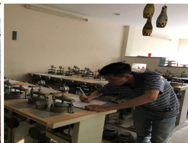
Hình 48: Thí nghiệm nén
