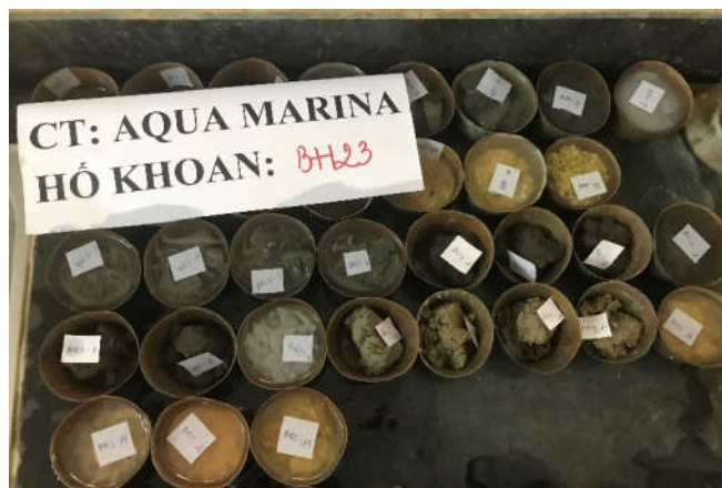
Hình 44: Thí nghiệm thành phần hạt
